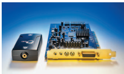
Адаптер Coaxial-to-Toslink Converter компании SIIG (слева) соединяет цифровые аудиоports ПК и аудиоусилителя
